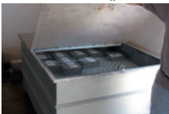
Vasca termostata per la corretta maturazione dei provini
