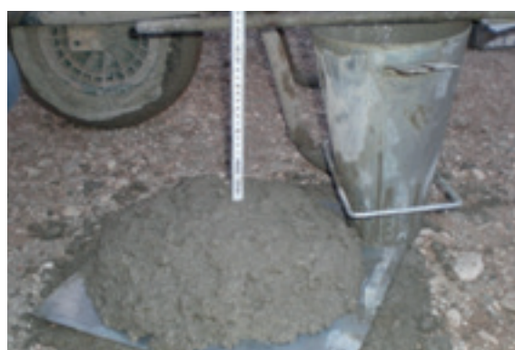
Misura dell'abbassamento al cono di Abrams "slump"
