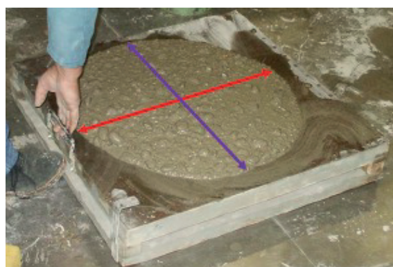
Misura dello Spandimento - Diametro di spandimento = (d_1 + d_2)/2
